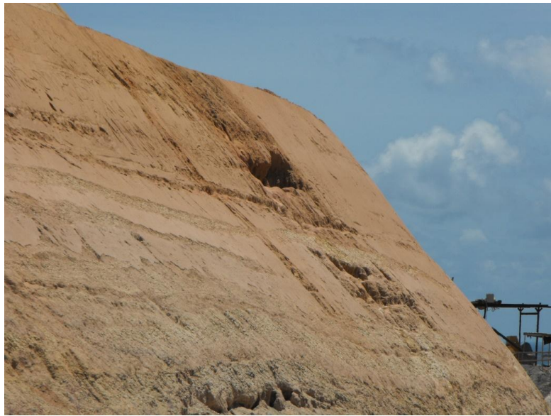
Corte na Formação Barreiras, mostrando litologia de aspecto vermelho amarelado, com granulometria arenosa de baixa plasticidade e baixa coesão, susceptível a processos erosivos pelo escoamento superficial. Foto de Referência na Av. Josefa de Mello.
