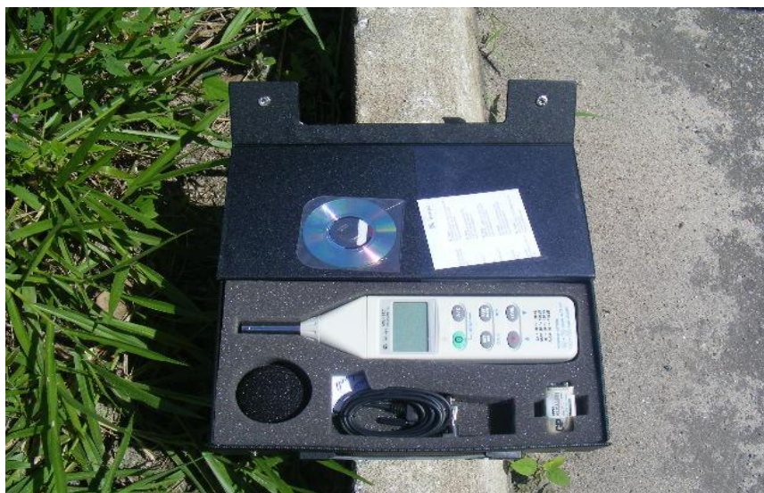
Equipamento usado para o levantamento de ruído no entorno da intervenção
