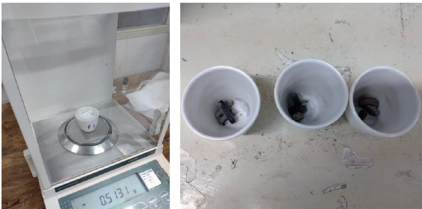
Figura 5 – A) Pesagem do polietileno sendo executada para a análise de umidade. B) Resíduos do PVC após experimento de determinação de cinzas.
